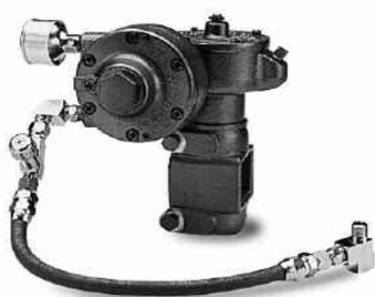
Moto-réducteur pneumatique 1/2 CV Rapport 15:1 - 20 à 120 tr/min - Vanne de réglage - Tuyau et raccords liaison air sur couvercle réservoir Référence : 183S-1013 / 183S-1513
